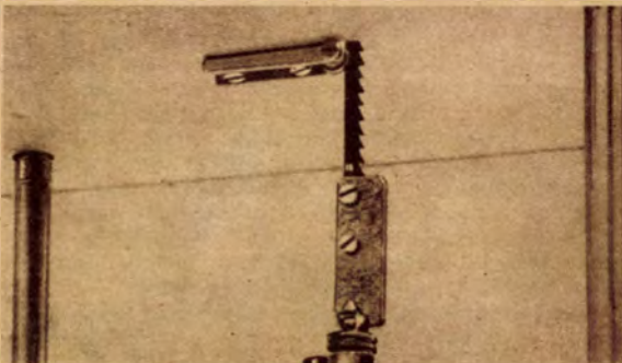
Az asztallap alsó lapjára szerelt fűrészlap-vezetőgörgő
